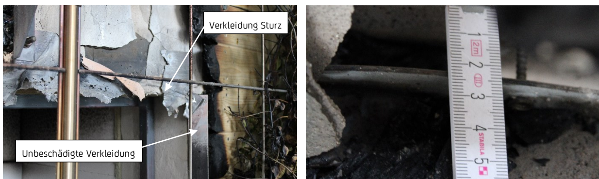
(a) Ansicht der Brennkammerleibung
