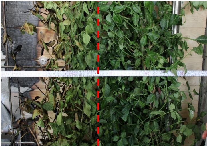
(a) Links der roten Linie ist die Begrünung durch die thermische Belastung bereits ausgetrocknet. Auf der rechten Seite hat die Begrünung den gleichen Zustand wie vor dem Versuch.
